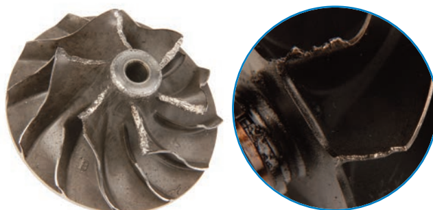
Danni all'induttore della Girante Turbina
